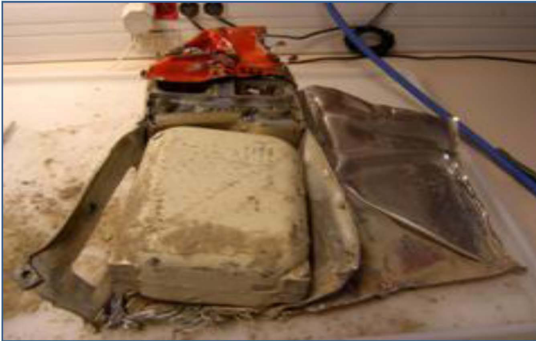
Fig. 38 : Enregistreur de paramètres de vol (FDR) ouvert.
