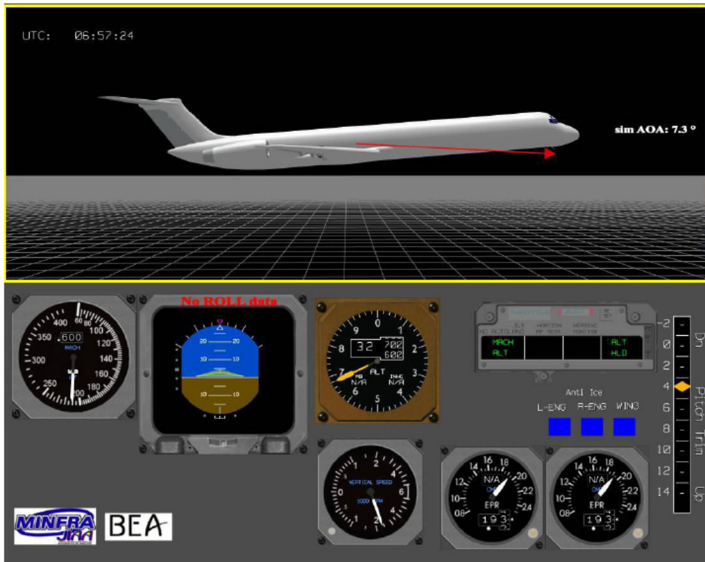
Fig. 49 : Simulation du vol sur la base des paramètres du FDR.
