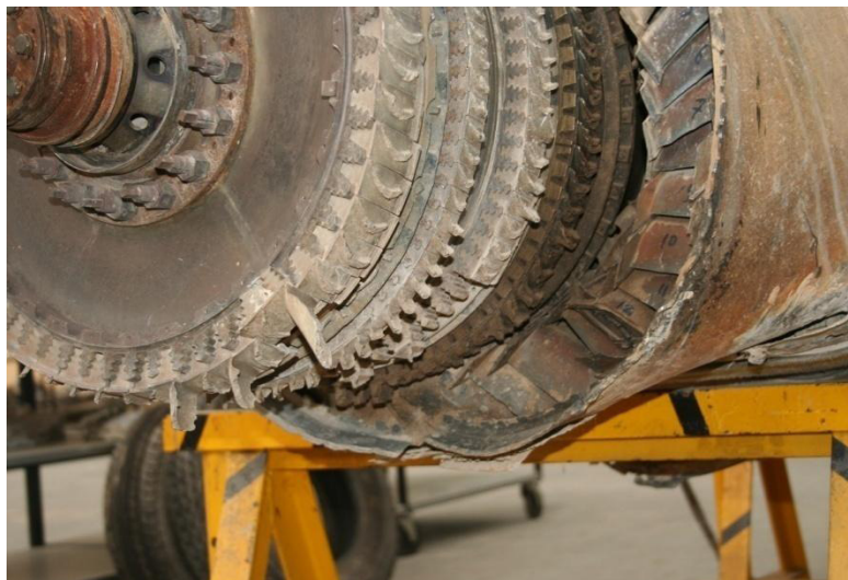
Fig. 46 : Turbine haute pression.
