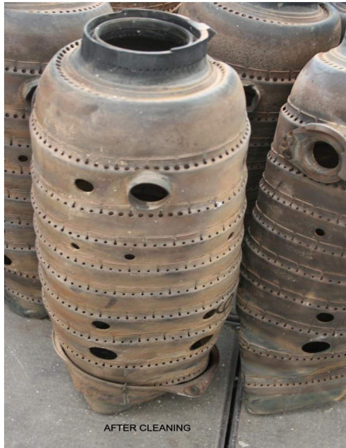
Fig. 42 : Chambres de combustion du moteur n° 1.
