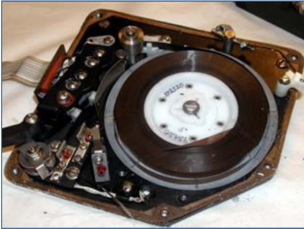
Fig. 36 : Bande magnétique et mécanisme du CVR.
