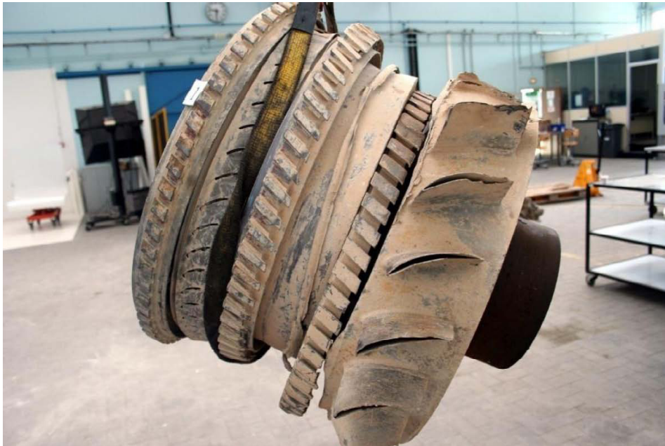
Fig. 41 : Compresseur basse pression du moteur n° 1.
