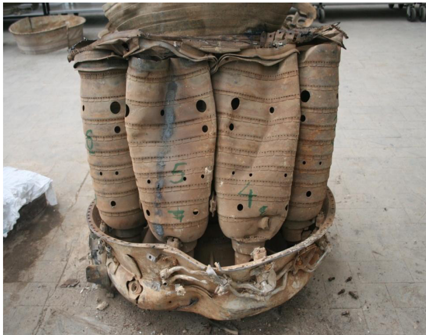
Fig. 45 : Chambres de combustion du moteur n° 2.
