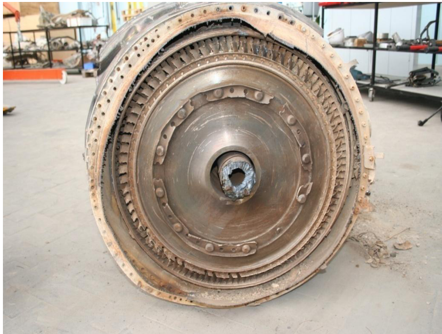
Fig. 44 : Compresseur haute pression du moteur n° 2.
