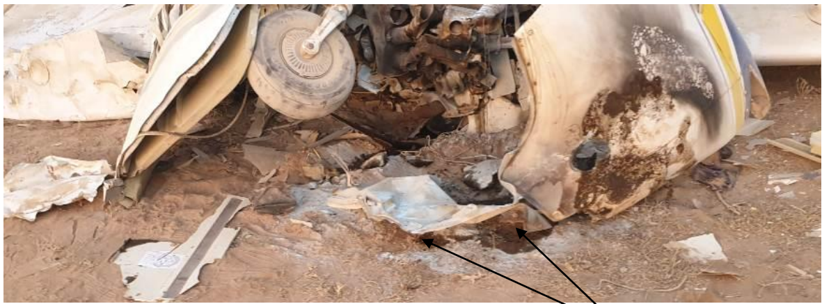
Traces carburant sur le sol
