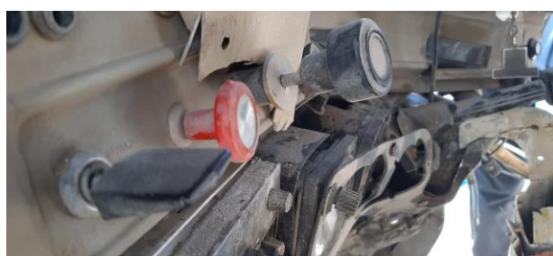
Manette de richesse du carburant en position mélange plein riche
